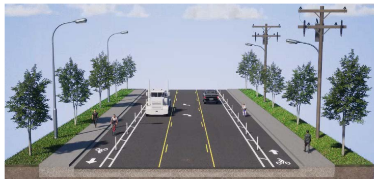
Un ejemplo de carretera con LTS 2 para peatones y ciclistas.
