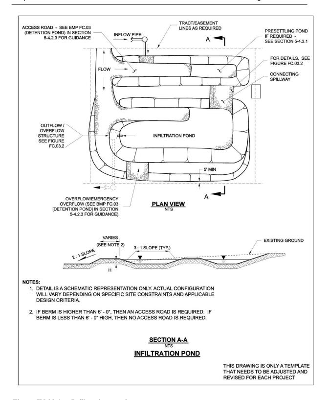
Figure IN.02.1 Infiltration pond.
