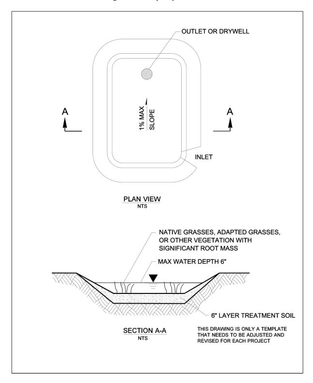
Figure IN.01.1 Bioinfiltration pond.
